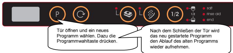
**Hinweis:** Wenn die Tür des Gerätes geöffnet wird, um das Spülprogramm abzubrechen, bevor es komplett durchgelaufen ist, öffnen Sie die Tür zunächst nur einen Spalt, um das Herausspritzen von Wasser zu vermeiden.
